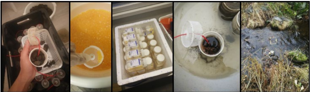
Kuva 3. Mädin selviytymistä seurattiin pitkin talvea nostamalla sylinterit yksi kerrallaan marras-, tammi-, maaliskuu- ja huhtikuussa. Nostot ajoitettiin siten, että ensimmäisellä nostolla selvitettiin kuljetuksen aiheuttama kuolleisuus, joka oli keskimäärin 12 %. Muut nostokerrat ajoitettiin siten, että syys- ja kevättulvat ja niiden mukana mahdollisesti kulkeutuva sulfaatti olivat ehtineet vaikuttaa mätijyviin.
