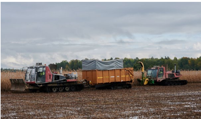
Kuva 6. Kahden latukoneen yhdistelmä, jossa etummainen kone vetää peräkärriä, johon takana tuleva niittokone puhalttaa niitetyn ja murskatun ruokosilpun.
