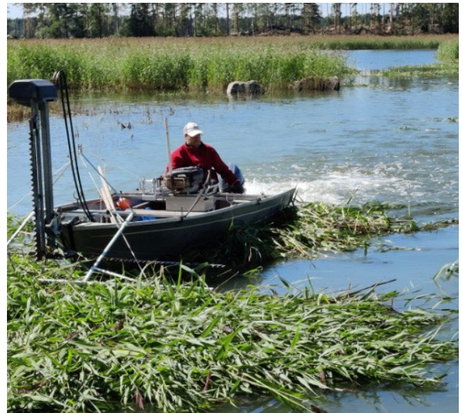
Kuva 10. moottoriveneeseen asennettu niittoterä ja harava, jonka avulla niitettyä ruokoa työnnetään haluttuun suuntaan.
