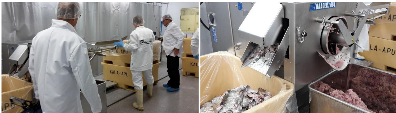
Kuva 5. Kala-Apu Oy:n massauskone erottelee kalasta pois ruodot ja nahan. Kuvat: John Nurmisen Säätiö
