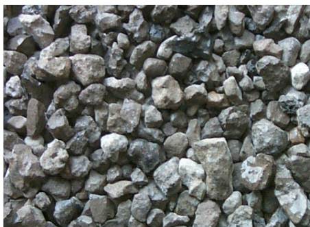
Steel slag waste
